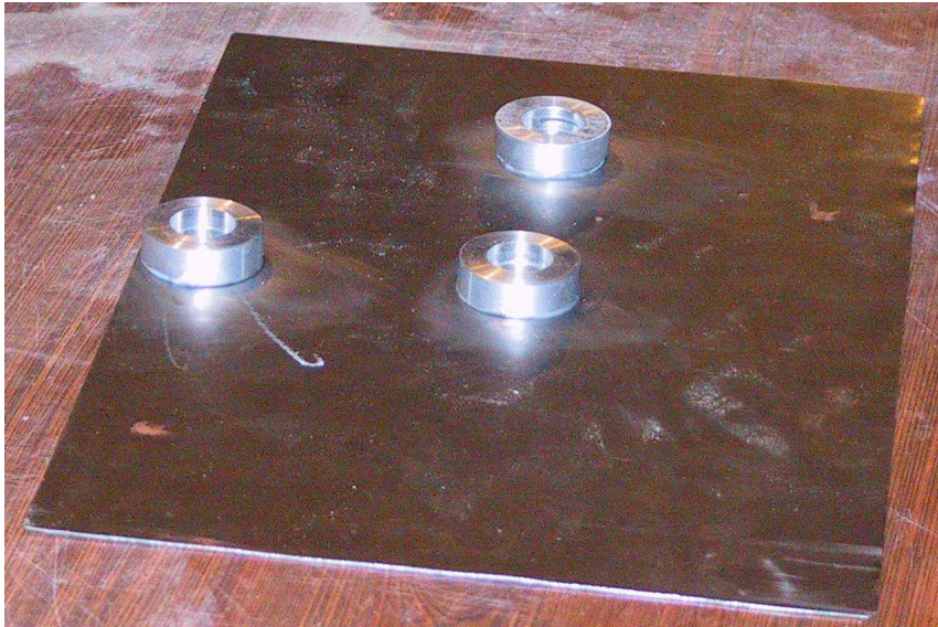
FIGURE 2.3 – La face inférieure du plateau, avec les trois supports de rotules.
