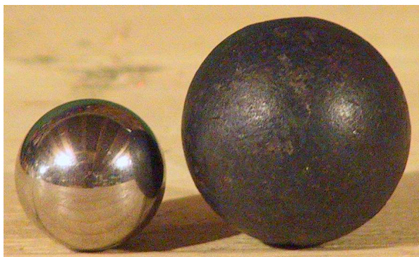
FIGURE 4.3 – Billes : à gauche, une bille de flipper, dont l’usage avait été initialement prévu. À droite, une bille de fer forgé, suffisamment lourde pour être détectée de manière fiable par la dalle tactile.
